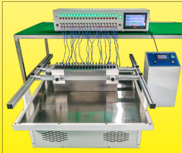
Apparecchiatura di test per misurare la resistenza alle vibrazioni degli interruttori pneumatici e il contatto a lenta azione dei pressostati mediante simulazione delle condizioni di trasporto (Laboratorio Ultimheat)
